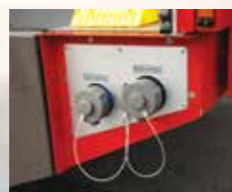
Входные отверстия для воды
