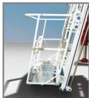
4. Лестница оснащена специальным вспомогательным выдвижным рельсом для опускания лифта до земли, что позволяет осуществлять посадку/высадку людей и пожарных не только через лестницу на поворотном устройстве, но и от земли, что более удобно и эффективно.
