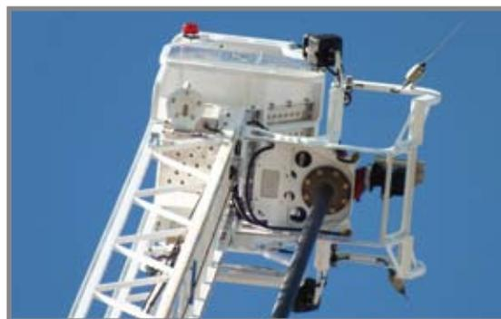
8. Спасательная лестница «Эвердайм» имеет также телескопического типа сухотруб для подачи воды в места пожаротушения. Он изготовлен из алюминия, что предотвращает коррозию. Диаметр телескопического сухотруба в среднем 65 мм в зависимости от колен.
