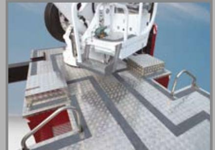
2. Пожарная машина имеет противоскользящие алюминиевые пластины и ступени лестницы также покрыты противоскользящими защитными пластинами.
