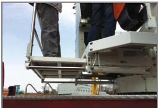
3. Для удобства и увеличения рабочей зоны Оператора, поворотное устройство с главной панелью управления оснащено выдвижной ножной платформой
