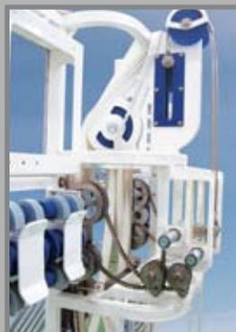
2. Скорость подъема лифта по лестнице 1 м/сек. и скорость опускания от 0,5-1 м/сек. Вместительность лифта – 3 человека. Раскладной лифт имеет увеличенную ширину в верхней части для удобства с учетом обмундирования пожарных, а также специальная структура лифта позволяет выполнять эффективно спасательные операции.
