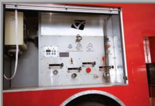
7. Каждая пожарная машина изготавливается и комплектуется по желанию Потребителя с учетом особенностей ее эксплуатации и предназначения. В качестве опции в зависимости от модели и шасси, могут быть установлены дополнительно насос для подачи воды и цистерна.
