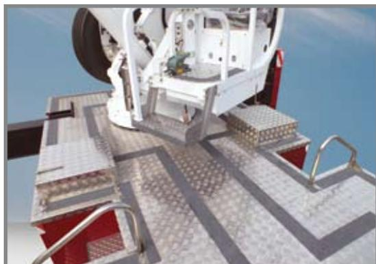
3. Пожарная машина имеет покрытие из алюминиевых пластин с противоскользящими нарезками, что также предотвращает появление коррозии и обеспечивает долгосрочную защиту, увеличивая срок ее эксплуатации.
