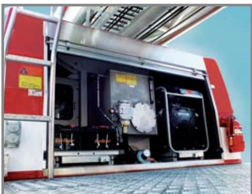
4. Аккумуляторные батареи и вспомогательный двигатель, расположенные внутри отсека, установлены на легко выдвижные рельсы, что дает дополнительное удобство при работе с ними.
