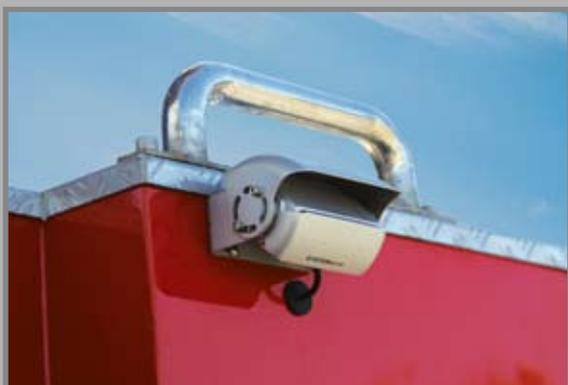
2. Камера заднего вида помогает при движении назад видеть всю картину с задней стороны пожарной машины и предотвратить столкновение с любым непредвиденным препятствием, что также очень удобно.
