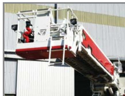
9. Новая модель спасательной лестницы также имеет люльку на вершине- опция. Вместимость люльки -3 человека. Люлька имеет дверь в середине, что обеспечивает удобство посадки. Внутри люльки имеется дополнительная панель управления, что также обеспечивает удобство управления при работах наверху.
