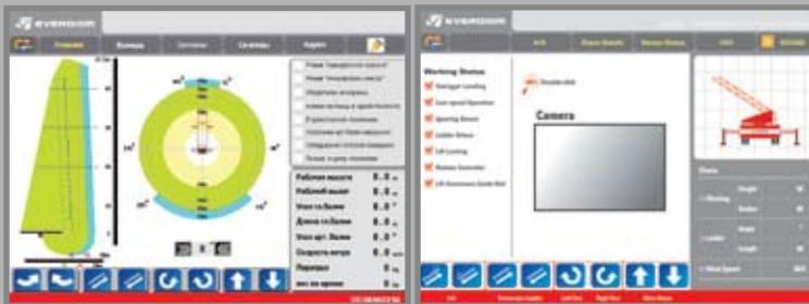
1. Главная панель управления для удобства имеет цветной сенсорный экран LCD с отображением основных движений и положения лестницы. Все данные отражаются на экране для наблюдения за текущей ситуацией. Имеется не только звуковое, световое отображение и предупреждение о действиях, но и, в виде опции, имеется голосовое сопровождение и предупреждение на соответствующем языке.
