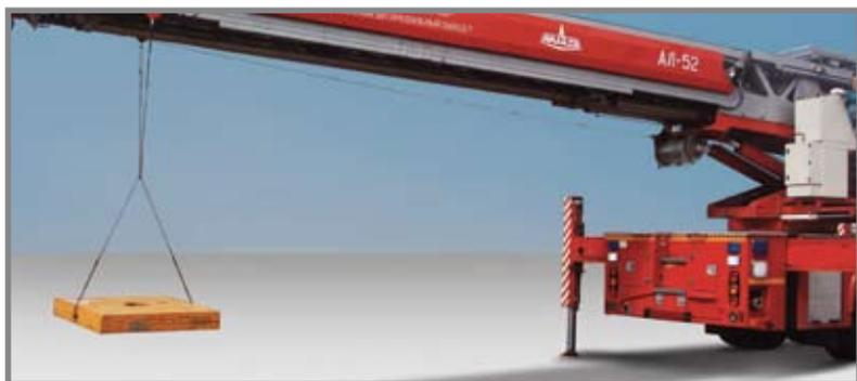
7. Несмотря на то, что основным предназначением лестницы является спасение людей и пожаротушение, ее, в случае крайней необходимости, можно использовать для перемещения тяжелых грузов весом до 2 тон, что иногда требуется при спасательных операциях. Грузовой крюк имеет также сенсор нагрузки с отражением данных на главной панели управления и блокировки движения при перегрузке, что обеспечивает безопасность при движении с грузом на крюке и предупреждает отрыв опор от земли и опрокидывание.
