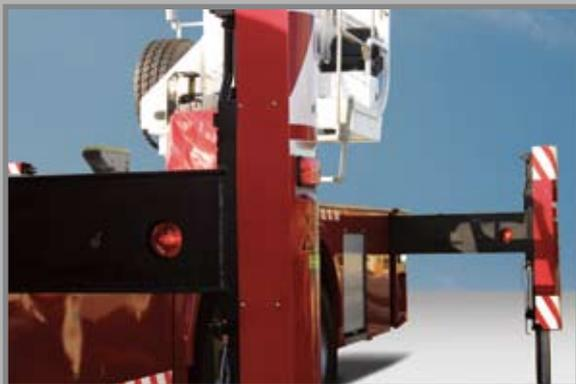
1. Отдельные части обшивки пожарной машины изготовлены из усиленного пластика, армированного стекловолокном (FRP), что обеспечивает отсутствие коррозии с одновременными противоударными защитными свойствами, что значительно влияет на уменьшение затрат на техобслуживание.
